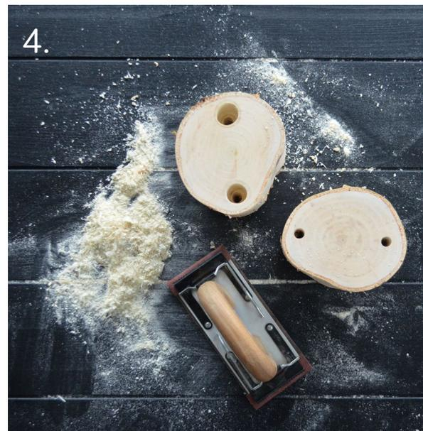
Anschließend müssen die beiden Stammstücke glatt geschliffen werden, um Holzsplitter und Unebenheiten zu entfernen.
