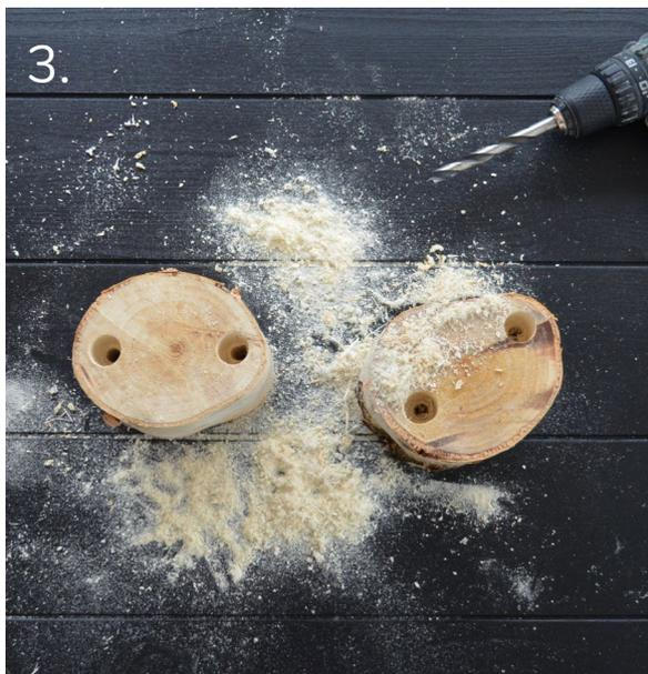
Jetzt werden die beiden vorhandenen Löcher mit dem 8 bis 10 mm Holzbohrer ganz durchgebohrt.
