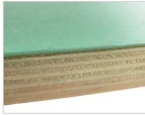
Podestboden: 25 mm stark, mit Linoleum beschichtet -> extrem belastbar und hygienisch
