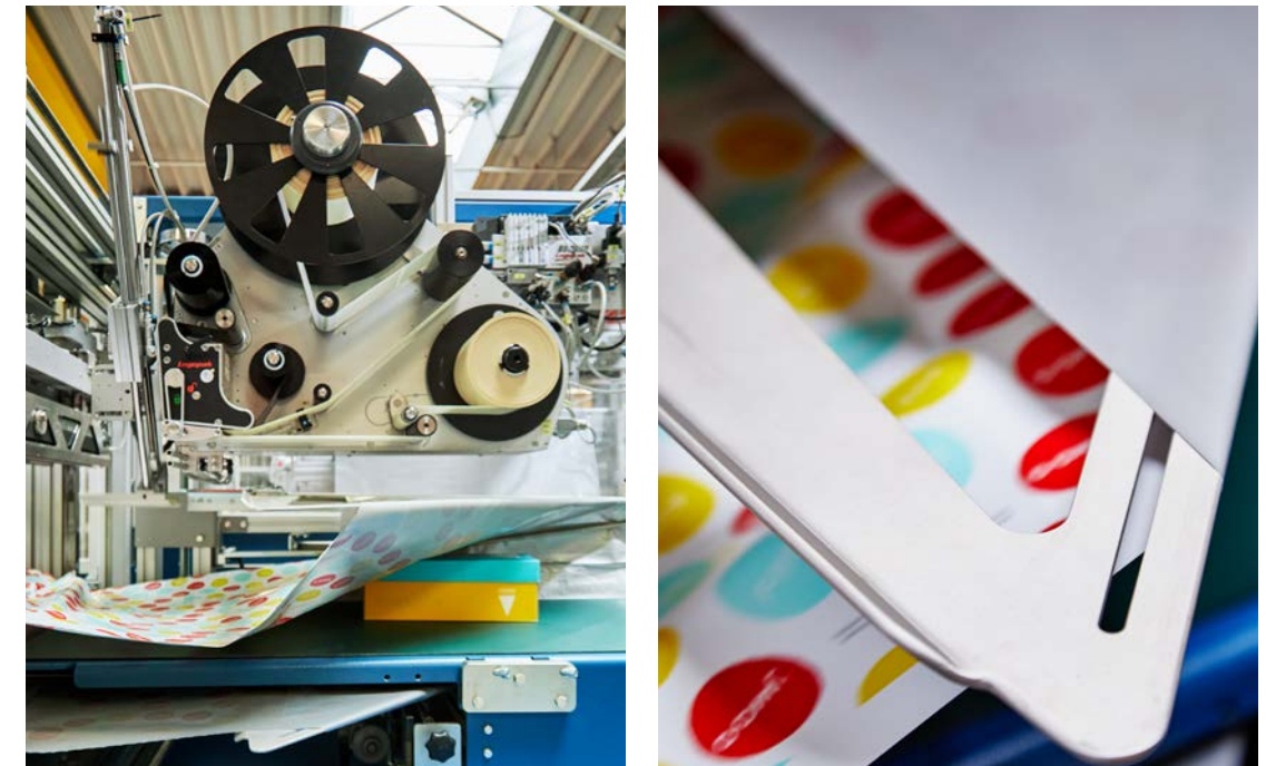
Die Tütenverpackungsmaschine erkennt durch optische Elemente die Größe eines jeden Produkts, schneidet die benötigte Folie ab, schweißt sie zurecht und druckt das zugehörige Etikett aus.
